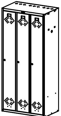
Конструкция шкафа предусматривает сборку или на саморезах, или на заклепках. В случае сбора на заклепках, они устанавливаются вместо саморезов, а также дополнительно в местах, указанных на рисунках.
